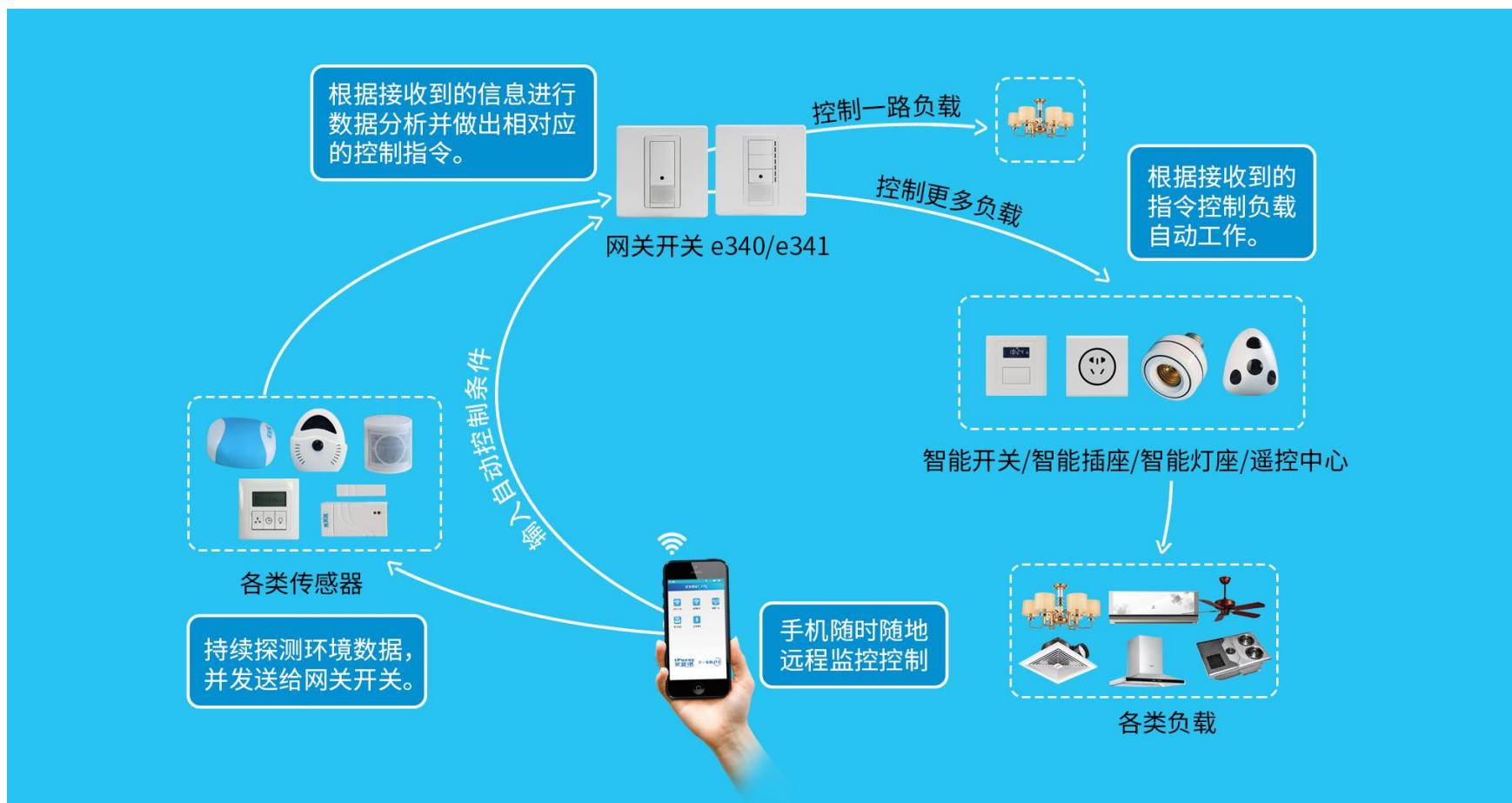
图二 智能家居系统工作流程示意图
