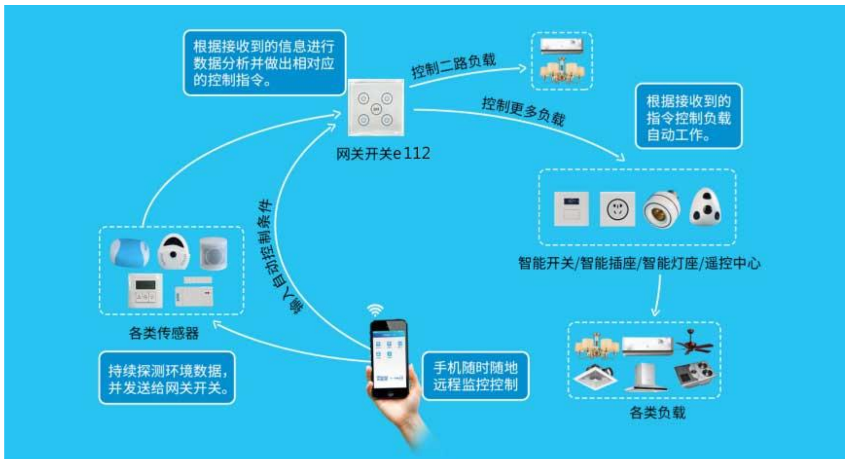
图二 智能家居系统工作流程示意图
