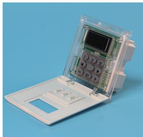
图五 内层面板结构
